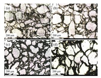
Fig. 3 OM images of the TPU/CNT composites (a)  $MS_{1.0}$ ; (b)  $CM_{1.0}$ ; (c) MS<sub>5.0</sub> and (d) CM<sub>5.0</sub>
